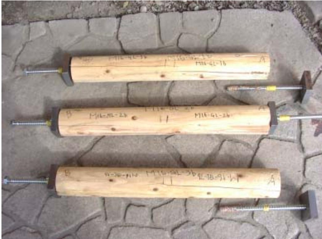
図—10 両引き試験 (M16) M16-GL-1b~3b
