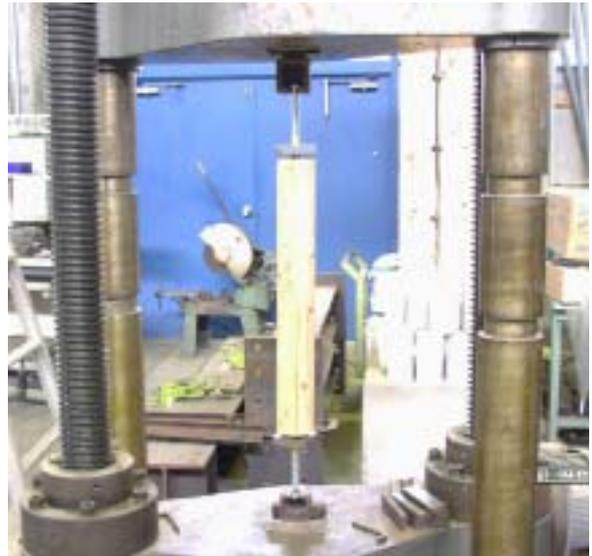
図—6 ラグスクリー引抜き試験
