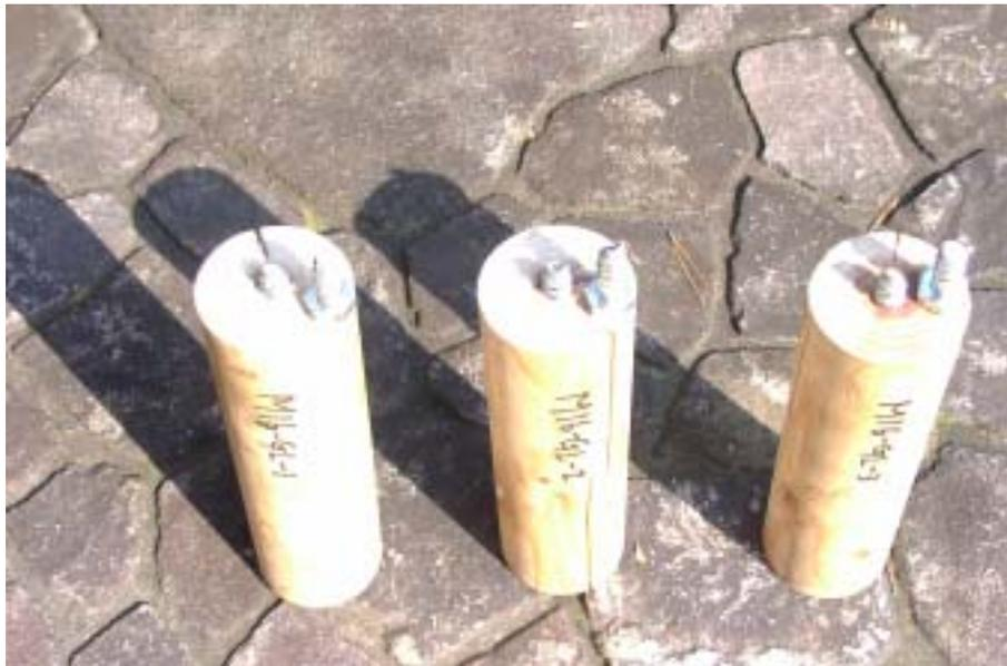
図—8 ラグスクリュー切断（片引き）M16-GL-1～3
